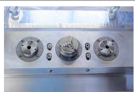
DBF63 auf Drehvorrichtung für das Elektronenstrahlschweißen
